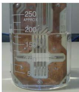
Fig. 3. Sensor de electrodos de hilo (transmisor 1 y receptor 4 hilos), realizado en un becker de 250 ml.
