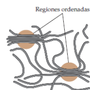
Figura 3. regiones cristalinas o de ordenamiento y alineación de las cadenas dentro de un polímero, marcadas con un círculo. obtenido de química la ciencia central Brawn y LeMay (Brown et al., 2009)
