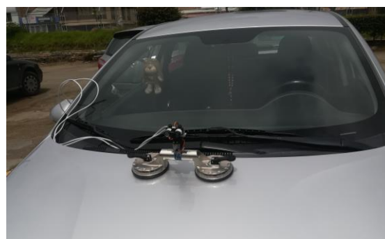
Fig 5. Instalación del sensor en el vehículo
