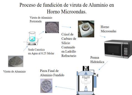
Fig. 1. Esquema del proceso de fundición de viruta de aluminio en horno microondas.
