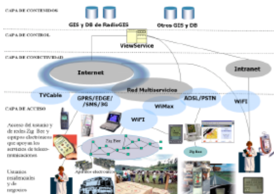
Fig. 2: Modelo de Red propuesto por RadioGIS para el desarrollo de Servicios NGN
