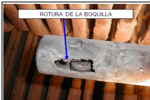
Fig. 4. Fractura de la boquilla debido al Creep.
