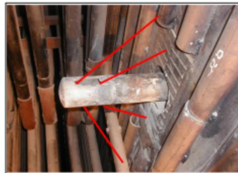
Fig. 6. Falla en la boquilla del deshollinador
