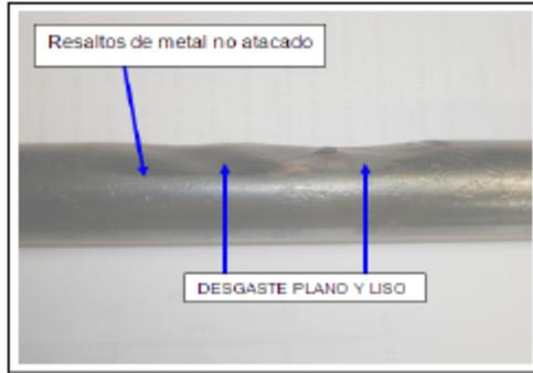
Fig. 3. Desgastes localizados en el tubo con diferentes inclinaciones.
