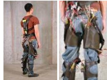
Fig. 4. Exoesqueleto Neumático Blando
