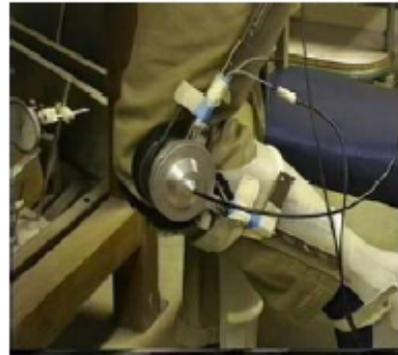
Fig. 1. Órtesis de rodilla con actuador de resorte.
