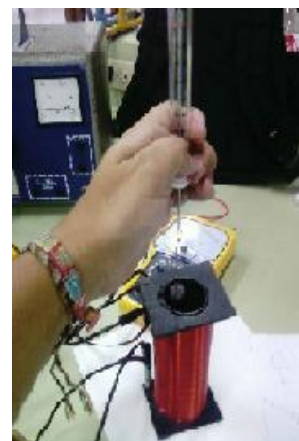
Fig. 8. Experimento: relación campo magnético vs. fuerza.
