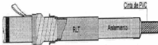
Fig. 4. Montaje del repartidor lineal de tensión (RLT) y cinta de PVC sobre un terminal del cable.
