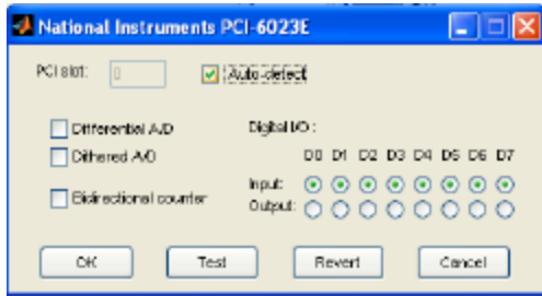
Fig. 6. Menú para el test de la DAQ National Instruments PCI 6023E
