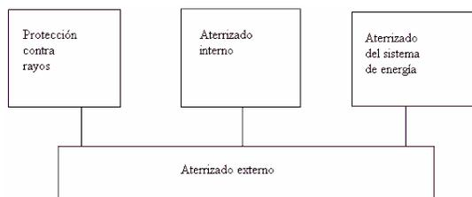
Fig. 7. Descripción conceptual del sistema aterrizado de una instalación industrial
