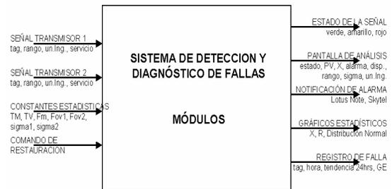
Fig. 4: Entrada-Proceso-Salida del SDDF
