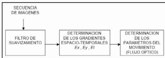
Fig. 6. Determinación de los parámetros del movimiento por el método de Yamamoto
