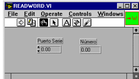
Fig. 3 Panel frontal del instrumento virtual que lee 4 dígitos del puerto serie
