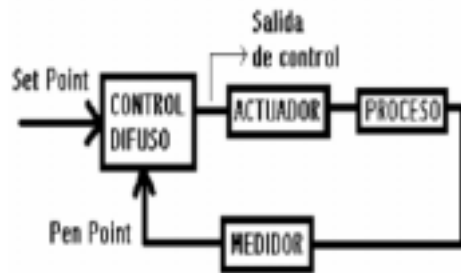
Fig. 7. Estructura de Control
