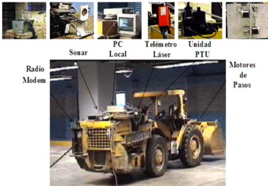
Fig. 6. Construcción del Vehículo Autónomo, consiste del vehículo “scoop tramp”, la unidad PTU y el telémetro láser, así como de los componentes necesarios para
