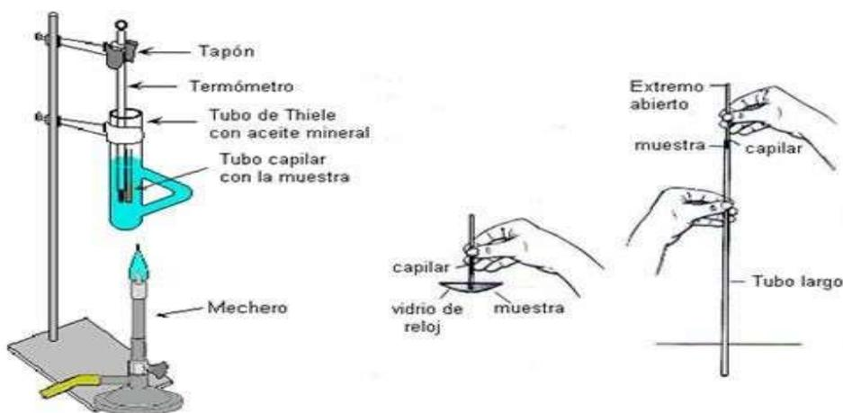
Figura 2. Medición de la temperatura de fusión
