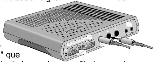
El generador de señales está fijado automáticamente para dar un voltaje de salida en CC de 10 voltios cuando se inicie la recogida de datos.
