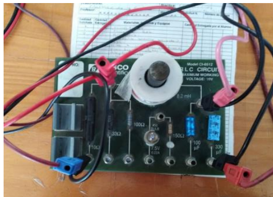
Montaje 6. Circuito RLC con la barra en el inductor
