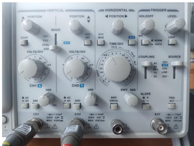
Montaje 2: tablero de comandos del osciloscopio analógico.
