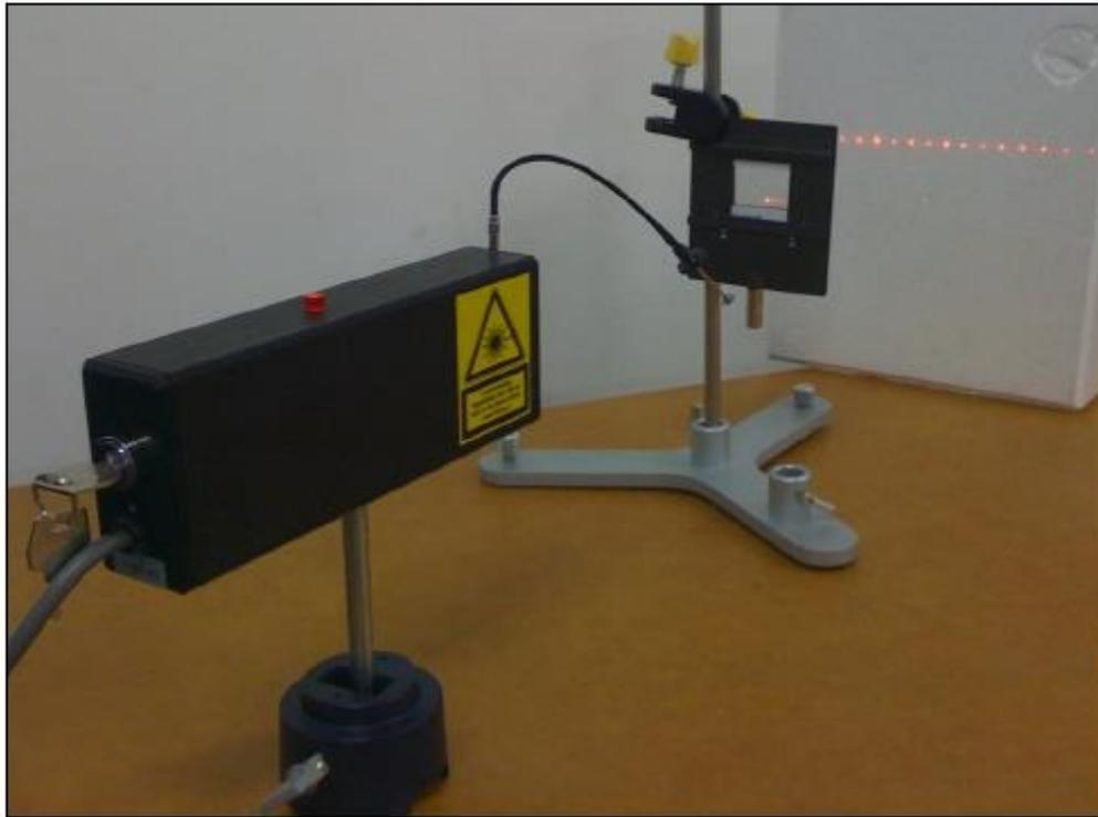
*Figura 9.2: Montaje para el cálculo de los órdenes de difracción.*
