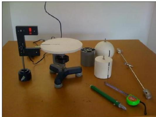
*Figura 4.1: Montaje para la determinación del periodo de un péndulo de torsión*
