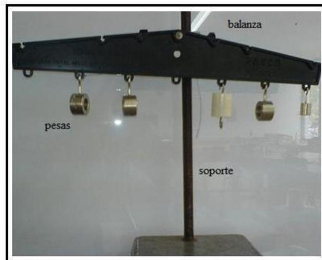
Figura 1. Balanza de fuerzas paralelas
