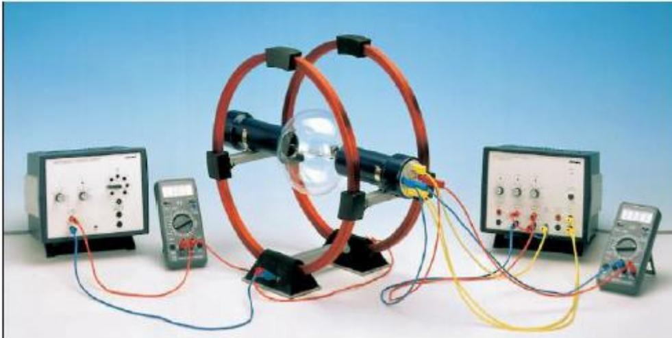
Figura 1: Montaje para la determinación de la relación carga masa
