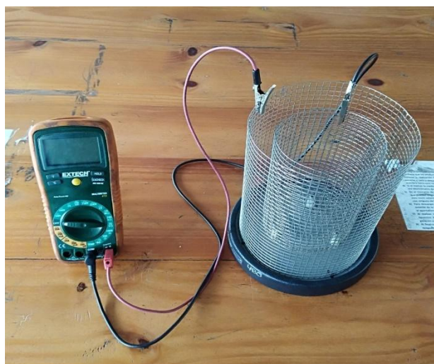
Montaje 1. Conexión multímetro a la jaula de Faraday
