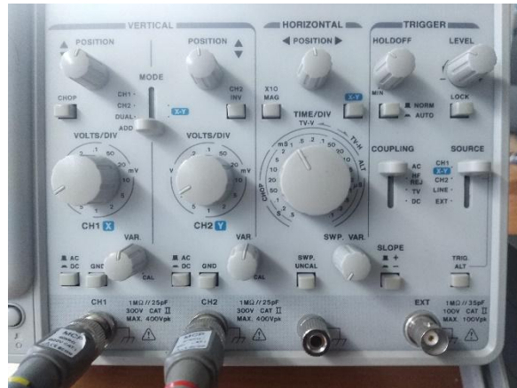
Montaje 2: tablero de comandos del osciloscopio analógico.
