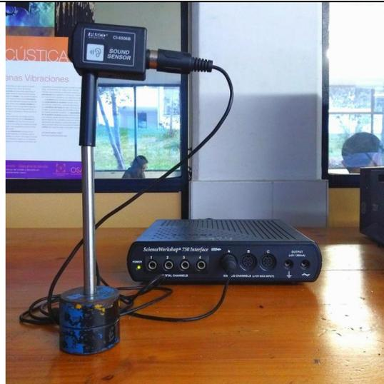
Montaje 1. Conexiones interface Science Workshop 750, con el sensor de sonido.
