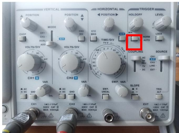
**Montaje 5: Botón x-y para la formación de las figuras de Lissajous.**
