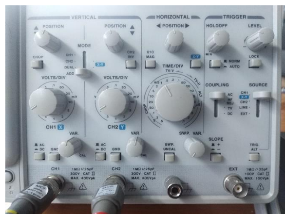
Montaje 2: tablero de comandos del osciloscopio analógico.
