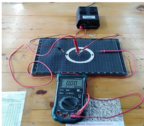
Montaje 3: conexión fuente de voltaje a la configuración de fuente puntual y anillo de protección, con ubicación de multímetro para realizar medición.
