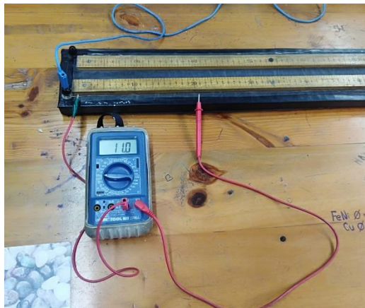
Montaje 2. Conexiones del multímetro al conductor de FeNi, para la toma de datos.
