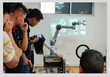
Cabe destacar que este brazo robótico puede ser programado con software abierto, lo que permite acceder a todas las variables involucradas en los procesos, ampliando así las fronteras académicas e investigativas. Además, este brazo robótico permite la interacción física con humanos en un entorno de trabajo colaborativo.
